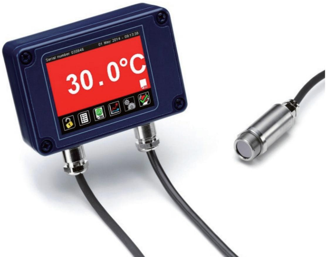
高機能タッチスクリーン付変換器で簡単設定・データロギング・microSDカードデータ保存
